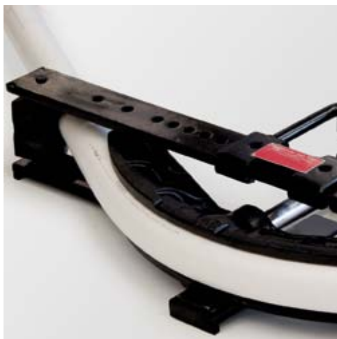
90x7 méretű cső hajlítása hajlítógéppel
