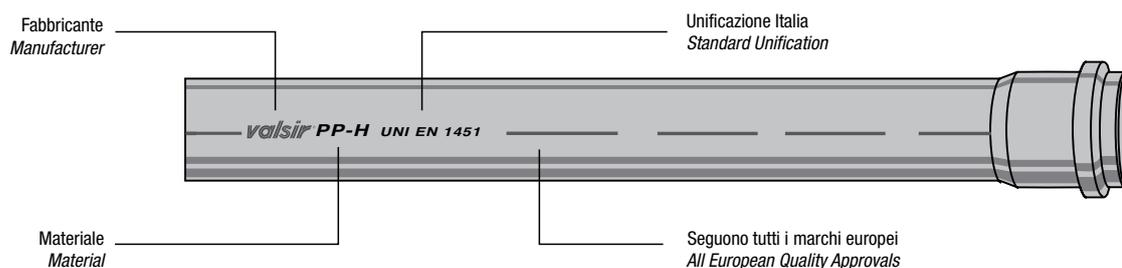
Fig. 2 Marcatura della raccorderia. - *Marking of the fittings.*
